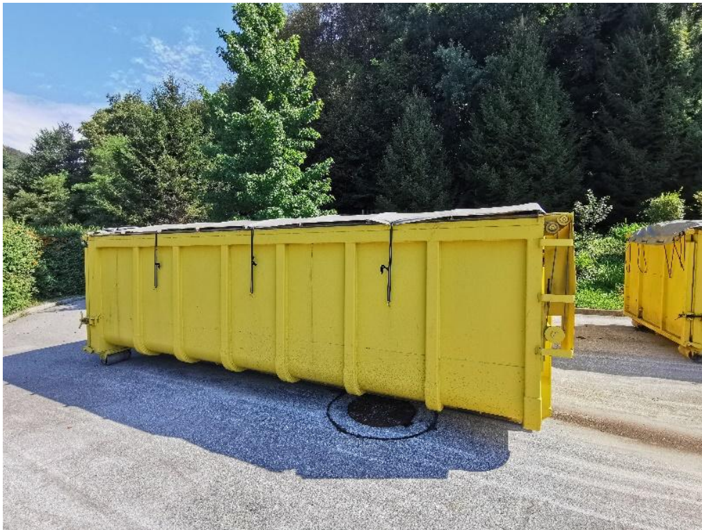
Slika 5: Cerada na način zapiranje/odpiranje s pomočjo jeklenih vrvic
