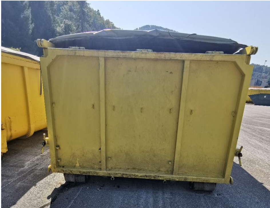
Slika 3: zadnja enokrila vrata na kip sistem z dvojnimi zapiralnim sistemom
